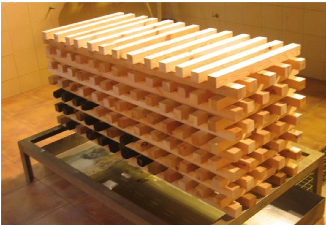
En la fotografía puede verse un hogar tipo 13 A, en el que las vigas longitudinales tienen una longitud de 1.300 mm, que en decímetros equivalen a 13 dm, de donde se deriva el número del hogar, 13.
