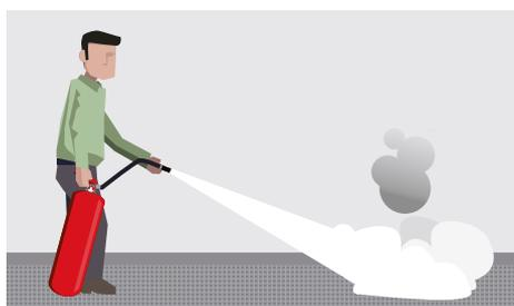
6. Dirija el chorro del extintor a la base del objeto que arde hasta la total extinción o hasta que se agote el contenido del extintor.
